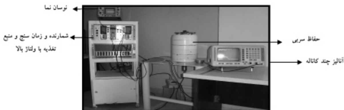
شکل ۴: نمای کلی سیستم آشکارساز بسته شده
