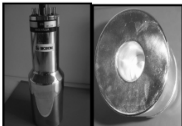
شکل ۲: نمای فوقانی و کناری آشکارساز سوسوزن یدور سدیم با ناخالصی تالیوم به ابعاد 3 \times 3 \times 3 همراه با تیوب فوتو مولتی پلایر
