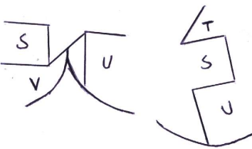
شکل شماره ۲ وضعیت سه فلاپ S, T, U را بعد از چرخش و چگونگی قرار گرفتن آنها در کنار یکدیگر نشان می دهد.
